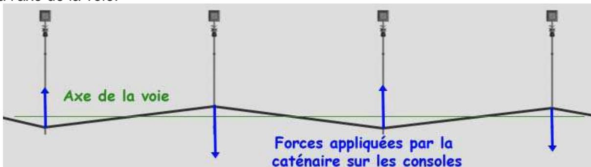
La force appliquée par la caténaire suivra les flèches bleues. On voit que les forces sont dans un sens opposé un poteau sur 2, ce qui est dû au fait que la caténaire va essayer de se "redresser" et donc de se mettre en ligne droite pour s'aligner par rapport à l'axe de la voie.
