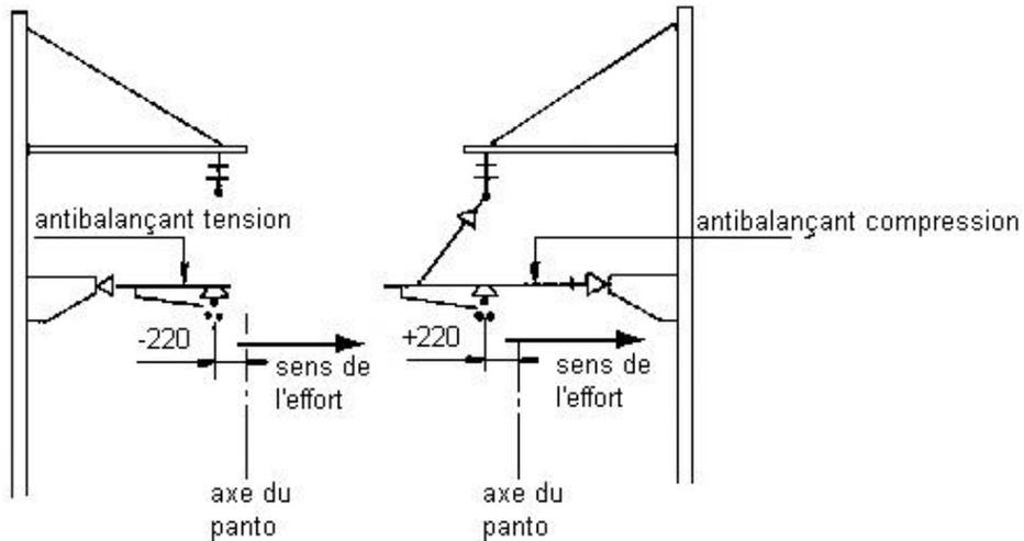
Le cas particulier de la voie en courbe : la caténaire est une ligne polygonale (qui a plusieurs angles) alors que l'axe du pantographe décrit un arc de cercle. Il faut donc limiter les portées de caténaire pour que le déport de celle-ci reste compatible avec les dimensions du pantographe.
