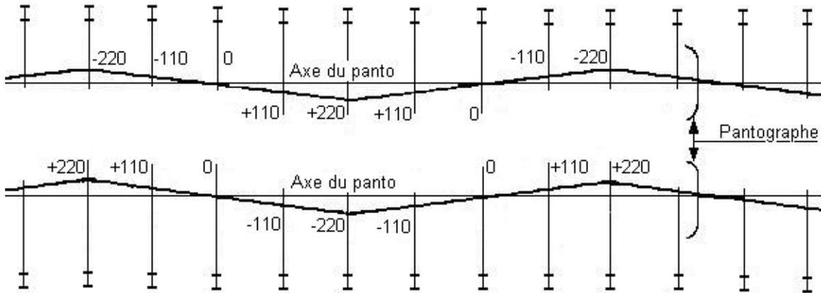
Pour éviter les points durs sur les fils de contact, les bras de rappel doivent toujours travailler mécaniquement en tension. Deux types de montage d'antibalançants sont donc réalisés : le montage TENSION et le montage COMPRESSION.
